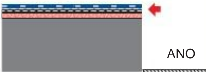
asfalt SE SEPARAČNÍ VRSTVOU
