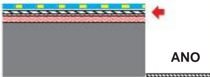
asfalt SE SEPARAČNÍ VRSTVOU
